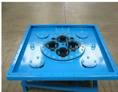
FIG.11) POSIZIONARE LE GUARNIZIONI PER LE FLANGE DEL COPERCHIO PASSO D'UOMO
