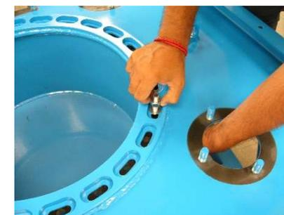
FIG.5) FISSARE I BULLONI CON RONDELLA E DADO BASSO, USARE I FORI DELLE FLANGE PER ESEGUIRE QUESTA OPERAZIONE
