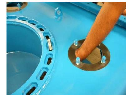
FIG.4) INSERIRE I BULLONI IN TUTTI I FORI TRA COLLARE, GUARNIZIONE E BASE
