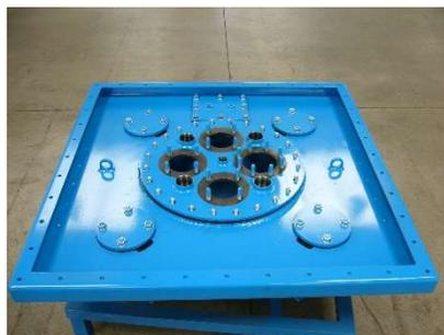
FIG.10) INSERIRE COPERCHIO PASSO D'UOMO SOPRA LA GUARNIZIONE
