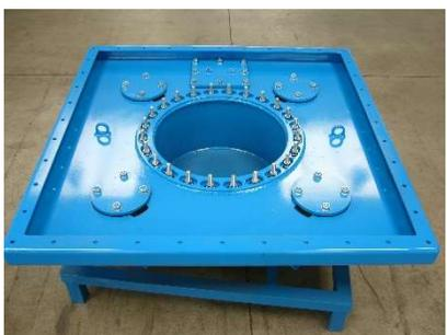
FIG.8) INSERIRE LE FLANGE, DADI E RONDELLE E POI AVVITARE A TENUTA
