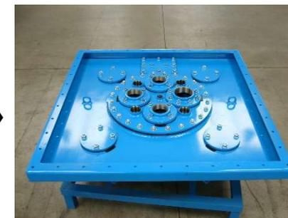
FIG.12) INSERIRE LE FLANGE, DADI MEDI E RONDELLE AVVITARE A TENUTA, **FINE MONTAGGIO.**
