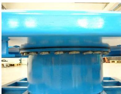
FIG.6) I BULLONI DEVONO ESSERE AVVITATI A MANO E NON CON LA PISTOLA PER FAVORIRE IL MONTAGGIO DEL COPERCHIO
