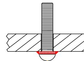
Prigioniero testa bombata per fissaggio attacchi saldato a tenuta al coperchio. Prigionieri: M10x45 M12x50 M16x55
