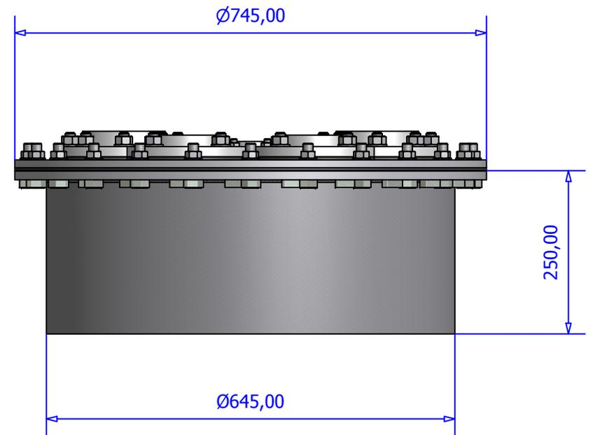
Le tolleranze dei nostri prodotti sono riportate nella specifica MTSP0301 ultima revisione. Le guarnizioni Antibenzina, da noi fornite, sono della serie **MTVC66.1/2@ NBR Fuel 70** (certificate) salvo diversa richiesta scritta da parte del cliente. I bulloni di fissaggio e le guarnizioni vengono consegnati a parte ed in apposita busta. **I nostri prodotti non sono progettati, fabbricati e omologati secondo la direttiva PED - Conformità attrezzature in pressione.**
