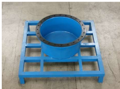
FIG.1) POSIZIONARE LA GUARNIZIONE SUL COLLARE DEL PASSO D'UOMO
