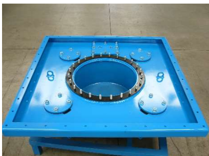
FIG.9) POSIZIONARE LA SECONDA GUARNIZIONE DEL COPERCHIO PASSO D'UOMO
