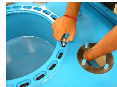
FIG.5) FISSARE I BULLONI CON RONDELLA E DADO, USARE I FORI SOTTO LE FLANGE PER FACILITARE QUESTA OPERAZIONE
