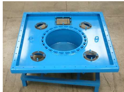
FIG.2) APPOGGIARE LA BASE DI ADATTAMENTO SUL COLLARE COMPLETO DI GUARNIZIONE
