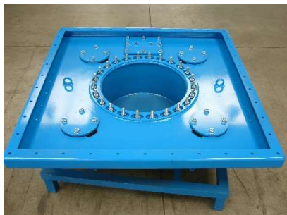
FIG.8) INSERIRE LE FLANGE, DADI E RONDELLE E POI AVVITARE A PISTOLA
