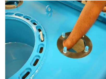
FIG.4) INSERIRE I BULLONI MOD. METALTERMO IN TUTTI I FORI TRA COLLARE E BASE
