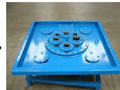
FIG.12) INSERIRE LE FLANGE, DADI E RONDELLE E AVVITARE A PISTOLA, FINE MONTAGGIO.
