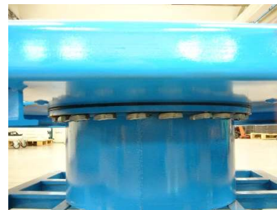
FIG.6) I BULLONI NON DEVONO ESSERE AVVITATI A PISTOLA MA SOLO A MANO
