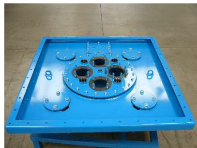
FIG.10) INSERIRE COPERCHIO PASSO D'UOMO SOPRA LA GUARNIZIONE
