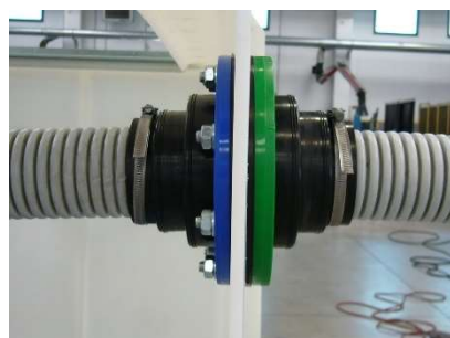
FIG.10) TAGLIARE LA GUARNIZIONE IN BASE ALLA MISURA NECESSARIA, PASSARE IL TUBO E SERRARE DA ENTRAMBE I LATI CON LE FASCETTE
