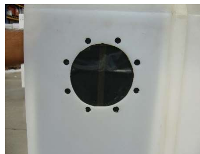
FIG.6) IL RISULTATO DEVE ESSERE COME SOPRA, Ø INTERNO E NUMERO DEI FORI VARIANO IN BASE ALLA TIPOLOGIA DI FLANGIA
