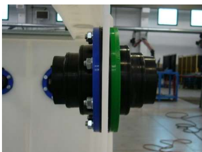
FIG.9) VISTA LATERALE DELLA FLANGIA MOD. FIRENZE PERFETTAMENTE MONTATA (UGUALE PER TOSCANA E PRATO)
